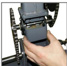
Die Aufgabevorrichtung (Turniquet) sorgt für Zuführung der bestimmten Pelletmenge in die Förderschnecke und zugleich erzeugt einen Raum über der Schnecke, der mit Luft getrennt ist. Die Konstruktion des Antriebes mit dem Kettengetriebe bei jeder Panne gewährleistet, dass es nicht zur Entflammung der Pellets im Behälter kommt. Zugleich ermöglicht die Konstruktion des Tourniquetes leichte Kontrolle und Reinigung, falls ins Tourniquet ein ungewünschter Stoff kommt und es wird geklemmt.
