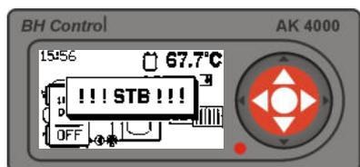
Bei der Fehleranzeige „STB“ kam es zur Kesselüberhitzung. Der STB ist aktiviert (Bild 3/7). Druckgebläse ist deaktiviert. Um den Kessel starten zu können, muss der „STB“ manuell entriegelt werden, wobei die Kesseltemperatur **60°C unterschreiten** muss. Anschließend wird durch Drücken der „ENTER“-Taste der Kessel wieder in Betrieb genommen.
