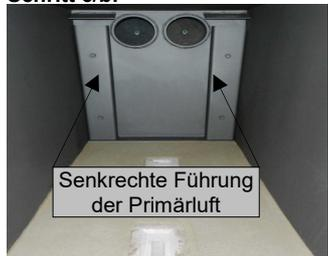
**Schritt 4:** Demontage des Trennbleches.
