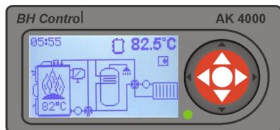
В режим горения котёл перейдёт после превышения температуры отставки продуктов сгорания ( $\text{end} + 10 \text{ }^\circ\text{C}$ ) или при достижении желаемой температуры. Режим горения это рабочее состояние в котором котёл управляется с помощью PID регулятором на основе температуры котла и температуры дымохода. Если температура котла превысит желаемую температуру на 1 °C мощность 0%, если температура упадёт на 2 °C ниже желаемой температуры, котёл снова наберёт мощность(для топлива „ДЕРЕВО“)
