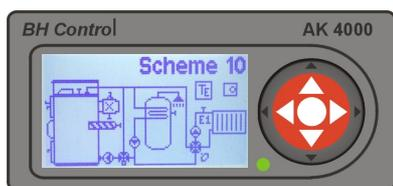
**Схема 10** с одним управляемым отопительным кругом ЦО с сервоприводом для половое или батарейного отопления. Обогрев ТВ управляется с помощью насоса. Температура ЦО может быть управляема на основе внешней температуры, комнатного термостата или их комбинацией. Охрану котла против низко-теплотной коррозии обеспечивает трёхходовой термостатический вентиль ESBE (60°C).
