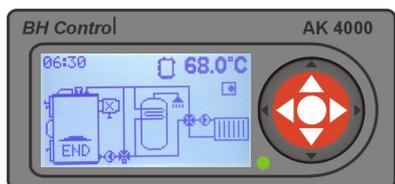
При понижении температуры продуктов сгорания ниже установленной температуры ( end) котёл автоматически отключится. На дисплее изобразится „END“. В случае если у вас настроен автоматический переход с топлива „ДЕРЕВО“ на топливо „ПЕЛЕТТЫ“ → котёл включится – режим разгорания гранул, а котёл продолжает работу в обогреве на желаемую температуру.
