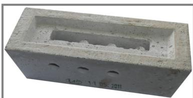
Огнеупорное сопло - это кирпич произведённый из специального огнеупорного бетона предназначенного к смешиванию газов с вторичным воздухом, результатом чего достигается безупречное сгорание. Кирпич установлен в подготовленное отверстие. Округ сопла выполнен из огнеупорного бетона до уровня сопла. Жизнеспособность сопла зависит особенно от механического повреждения при докладке дерева или при перемешивании топлива. Обмен сопла делайте при ее чрезмерном механическом износе.
