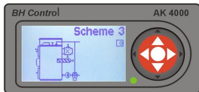
**Схема 3** Подключение с трёхходовым термостатическим вентилем ESBE (60°C). Насос подключить на силовую плату АК4000 к гнезду „Насос“. На гнездо Т3 силовой платы АК4000 возможно подключить комнатный термостат (п.17/B2). Описание работы котла с комнатным термостатом в п. 13.2.
