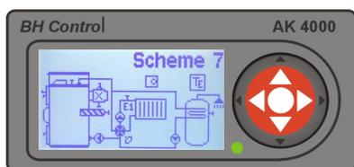
**Схема 7** для (ZSE-1) с одним управляемым отопительным контуром ЦО с сервоприводом для половое или батарейного отопления. Обогрев ТВ управляется с помощью насоса. Температура ЦО может быть урегулированная на базе внешней температуры, комнатного термостата или их комбинацией. Регулированный четырёхходовой смесительный клапан обеспечивает охрану котла против низко-теплотной коррозии
