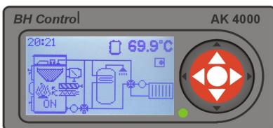
Режим разжигания обозначен символом „ON“. Это автоматический процесс с использованием отслеживания температуры в дымоходе.
