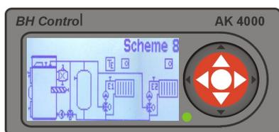
**Схема 8** с двумя самостоятельно управляемыми кругами ЦО и АКУ баком. Возможность выбрать половое, батарейное отопление или их комбинацию. Температура ЦО может быть управляема на основе внешней температуры, комнатного термостата или их комбинацией. Охрану котла против низко-теплотной коррозии обеспечивает трёхходовой термостатический вентиль ESBE (60°C).
