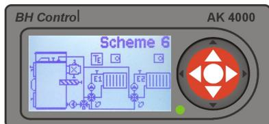
**Схема 6** с двумя самостоятельно управляемыми кругами с сервоприводом. Есть возможность выбрать половое отопление, отопление батарейное или их комбинацию. Температура ЦО может быть урегулированная на базе внешней температуры, комнатного термостата или их комбинацией. Самостоятельно управляемые насосы ЦО и котловой насос. Охрану котла против низко-теплотной коррозии обеспечивает трёхходовой термостатический клапан ESBE (60°C).
