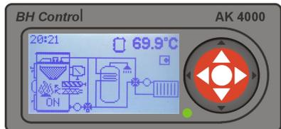
При выборе автоматического перехода 🔧 → 🔥 наиболее выгодно выбрать (🔥 end) до 60 °C что бы топливо „ДЕРЕВО“ полностью сгорело.
