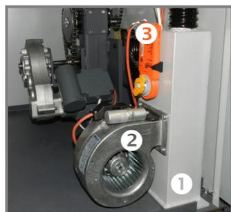
Воздухораспределитель „1“ это устройство, которое с помощью сервопривода „3“ обеспечивает автоматическое перенаправление воздуха поставляемого дутьевым вентилятором „2“ при смене топлива с „ДЕРЕВА“ на „ПЕЛЛЕТЫ“ и на оборот. Изменение положения серво изображено на дисплее ..
