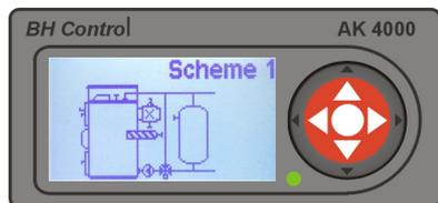
**Схема 1 для (ZS-3).** Подключение с аккумуляционным баком. Для охраны котла используется трёхходовый термостатический вентиль ESBE (60°C). Насос подключить на силовую плату АК4000S на гнездо „Насос“. На гнездо Т3 необходимо подключить термометр резервуара тип КТУ код 3032. (п.17/B3). Описание работы котла с АКУ баком в п. 10.1.6.
