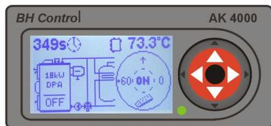
В режиме растопки котёл находится, если его выходная температура продуктов сгорания ниже чем настроенная минимальная температура продуктов сгорания. Минимальная температура, а также максимальная температура продуктов сгорания выбирается в настройках параметров котла. По стандарту настроена минимальная температура продуктов сгорания на 90°C и максимальная на 220°C. В режиме растопки может котёл находится 60 мин. минимально 2 минуты. По истечении время котёл автоматически отключится „END“.
