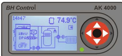
Если котёл находится в выключенном состоянии, который изображён на рисунке котла символом „OFF“, нажатием на среднюю кнопку „ENTER“ отобразится круговой регулятор.
