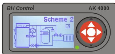
**Схема 2 для (ZS-2) Схема подобна схеме „0“** , только для регуляции воды в центральном отоплении используется трёхходовый смесительный клапан мануального управления
