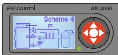
**Схема 4** Подключение с четырёхходовым вентилем мануально регулируемым, который используется для регуляции воды в центральном отоплении. Для обогрева тёплой воды используется комбинированный резервуар тёплой воды. Оба насоса подключить к силовой плате АК4000 совместно на гнездо „насос“. На гнездо Т3 силовой платы АК4000 можно подключить комнатный термостат(п.17/B2). Описание работы котла с комнатным термостатом в п.13.2.
