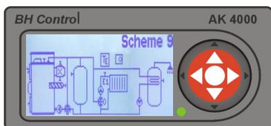
**Схема 9** для (ZSE-2) с одним управляемым отопительным кругом ЦО с сервоприводом и аккумуляционным баком. Обогрев ТВ управляемый с помощью насоса. Температура ЦО может быть управляема на основе внешней температуры, комнатного термостата или их комбинацией. Охрану котла против низко-теплотной коррозии обеспечивает трёхходовой термостатический вентиль ESBE (60°C).
