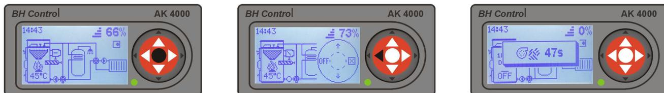
Нажатием кнопки „ENTER“ на дисплее изобразится круговой регулятор. Нажатием кнопки ◀ котёл выключится. После выключения котла автоматически включится дутьевой вентилятор. В течении 60сек. охлаждается горелка пеллет. Нажатием кнопки ☒ на дисплее исчезнет изображение кругового регулятора.
