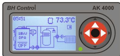
Если котёл находится в выключенном состоянии, который изображен на картинке котла символом „OFF“, легким нажатием кнопки „ENTER“ придёт в действие графический регулятор(дисплей).
