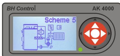
**Схема 5** с одним отопительным контуром ЦО для половое отопления или отопления с помощью батарей. Температура ЦО может регулироваться на базе внешней температуры, комнатного термостата или их комбинацией. Самостоятельно управляемый насос котла и насос ЦО. Управляемый четырёхходовой смесительный клапан с сервоприводом обеспечивает охрану котла против низко-теплотной коррозии.
