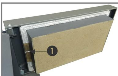
Дверца в котле стабилизированы в трёх точках, на двух поворотных креплениях и в месте замыкания. В случае не герметичности дверц возможно, кроме закрытия поворотным затвором, и дальнейшая регулировка со стороны шарнирных петель. Раскреплением и контргайкой можно покрутить гайкой шарнирных петель и так подвинуть дверца в желанном направлении. В случае замены уплотнения точкой 1 обозначено место, где вплотную соединяется.
