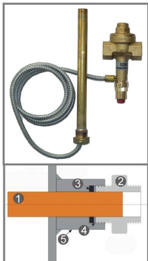
Безопасный теплообменник охлаждения вместе с выпускным клапаном Honeywell TS 131 охраняет котёл против перегрева в случае отключения электроэнергии. При принудительной циркуляции придёт к отставке насоса и остановке воды в системе ЦО. В случае если не обеспечен автоматический переход в гравитационное движение, или минимальный отбор тепла 5 kW, может придти к перегреву котла постоянным нагревом.
