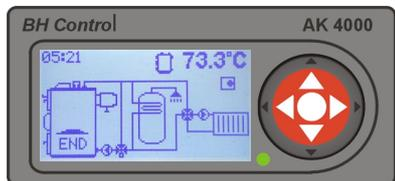
При понижении температуры газовых отходов ниже установленной температуры (🔥 end) котёл автоматически отключится. На дисплее изобразится надпись „END“. В случае если котёл настроенный автоматически на переход с топлива „ДЕРЕВО“ на топливо „ПЕЛЛЕТЫ“ 🔧 → 🔥, котёл включится – режим разжигания гранул и котёл дальше продолжает в обогреве на желаемую температуру.
