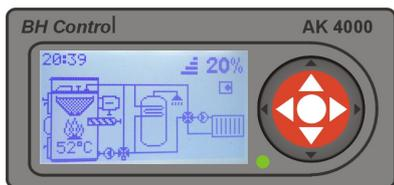
К режиму горения котла придёт после успешного возгорания гранул. Состояние обозначено „ON“ → „52°C“. В режиме горения котёл управляется с помощью PID регулятора на основании температуры котла и дымохода. Если температура котла превысит желаемую температуру на 1 °C мощность 0%, если температура упадёт на 3 °C ниже желаемой температуры, котёл снова включится произойдёт возгорание и наберёт обороты мощности. Актуальная мощность изображена в процентах символом напр. „20%“.
