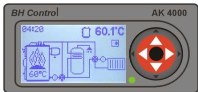
Используйте дисплей. Для запуска дисплея быстрым нажатием, нажмите среднюю кнопку ENTER. Дисплей предлагает возможность отключения котла , подачу топлива или отключение регулятора.
