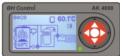
В режим горения котёл перейдёт после превышения температуры отставки продуктов сгорания (🔥 end) +10 °C или после достижения желаемой температуры. Режим горения это рабочее состояние при котором котлом управляет PID регулятор на основе температуры котла и дымохода. Если температура котла превысит желаемую температуру на 1 °C мощность 0%, если температура понизится на 2 °C ниже желаемой температуры, котёл снова набирает мощность (действует для топлива „ДЕРЕВО“)
