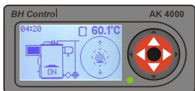
Подтверждением 🔧 отключите дутьевой вентилятор. С помощью удлиненной рукоятки откройте клапан дымохода, далее откройте верхние дверцы. Можете подать необходимое количество топлива. После дополнения топлива закройте верхние дверцы и клапан дымохода (пункт 11.4). Подтверждением 🔥 подачу топлива закончите. Автоматически включится дутьевой вентилятор. Котёл переходит в состояние разгорания „ON“ если выполнено условие далее перейдёт в режим обогрева.
