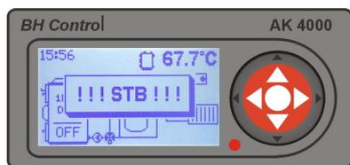
При неисправности „STB“ произошло перегревание котла. Активировался тепловой предохранитель. В таком случае вентилятор (рис.3/7) отключен от напряжения. Котел можно снова подключить только после механического нажатия охраны „STB“ (рисунок), причем температура котла должна быть ниже 60°C. Котел снова включится после подтверждения кнопкой ENTER“.
