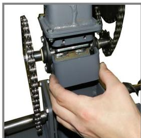
Камерный дозирующий бункер пеллет(конвейер) это устройство , которое дозирует определённое количество пеллет в шнек и совместно с этим воздухом образует отдельное пространство над шнеком. Конструкция привода с помощью цепной передачи при любой неполадке обеспечит то, что не произойдёт возгорание пеллет в резервуаре. Одновременно конструкция конвейера предоставляет лёгкий контроль и очистку в случае , если в конвейер попал посторонний предмет и заклинил его.
