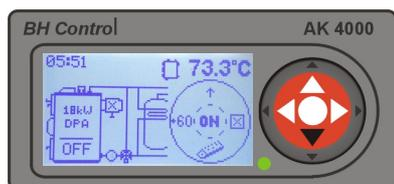
Кнопкой ▼ можете выбрать топливо пеллеты „“ или топливо дерево „“. При отоплении деревом выбирайте топливо „ДЕРЕВО“
